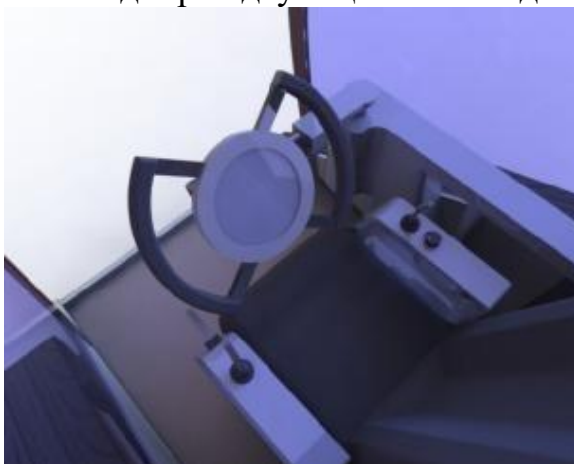
3.15 - сурет - Бір шөмішті экскаватормен қашықтан басқару құрылғысының прототипі
