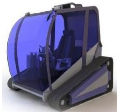
3.13 - сурет - бір шөмішті экскаватордың қашықтан басқару құрылғысының прототипі
